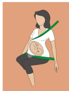
Poprawne użycie pasa biodrowego przy zastosowaniu Adaptera do pasów bezpieczeństwa dla kobiet w ciąży.
